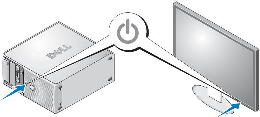
Πιέστε το κουμπί λειτουργίας στο σύστημα και την οθόνη. Πρέπει να ανάψουν οι ενδείξεις λειτουργίας. Ρυθμίστε τα κουμπιά ελέγχου της οθόνης ώσπου η εικόνα που εμφανίζεται να σας ικανοποιεί.
