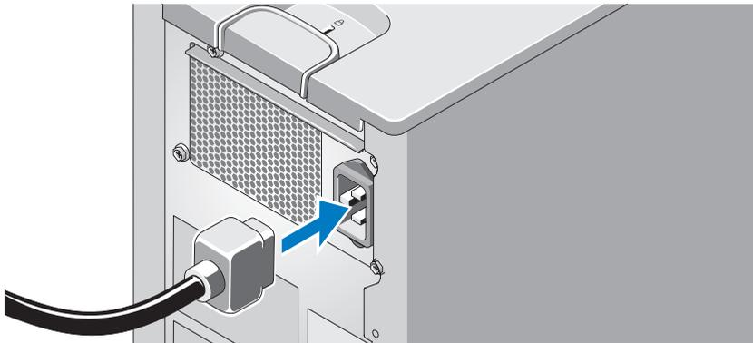
Conecte el cable de alimentación al sistema. A continuación, conecte el otro extremo del cable de alimentación a una toma eléctrica con conexión a tierra o a otra fuente de energía, como por ejemplo un sistema de alimentación ininterrumpida (SAI) o una unidad de distribución de alimentación (PDU).
