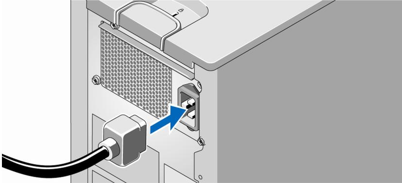
חבר את כבל החשמל של המערכת למערכת. הכנס את הקצה האחר של כבל החשמל לשקע חשמלי מוארק או למקור מתח נפרד כגון מערכת UPS או מערכת פיצול מתח (PDU).
