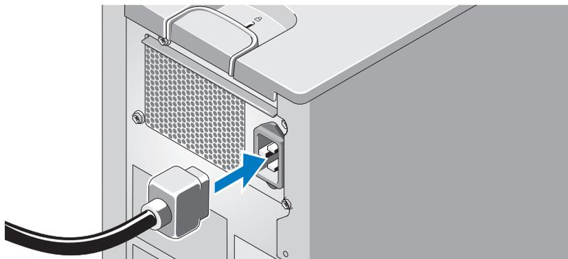
Подсоедините кабели питания к системе. Далее подключите другой конец кабеля питания к заземленной розетке или отдельному источнику питания, например источнику бесперебойного питания или блоку распределения питания.
