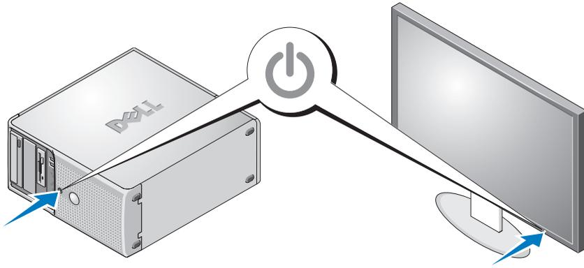
Presione el botón de encendido del sistema y del monitor. Los indicadores luminosos de alimentación deberían encenderse. Ajuste los controles del monitor hasta que la imagen mostrada sea satisfactoria.
