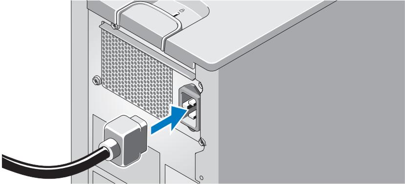
Συνδέστε το καλώδιο τροφοδοσίας στο σύστημα. Στη συνέχεια, τοποθετήστε την άλλη άκρη του καλωδίου τροφοδοσίας σε γειωμένη πρίζα ή σε ξεχωριστή πηγή ηλεκτρικού ρεύματος, όπως είναι ένα σύστημα αδιάλειπτης τροφοδοσίας (UPS) ή μια μονάδα διανομής ρεύματος (PDU).
