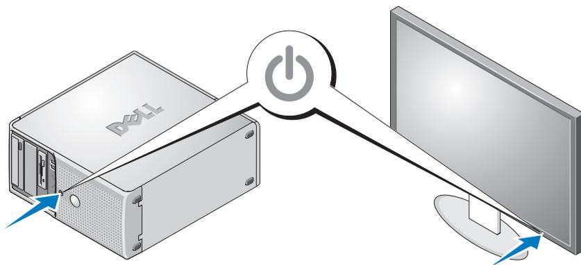
Naciśnij przyciski zasilania komputera i monitora. Powinny zaświecić się wskaźniki zasilania. Wyreguluj ustawienia monitora aż do uzyskania odpowiedniego obrazu.
