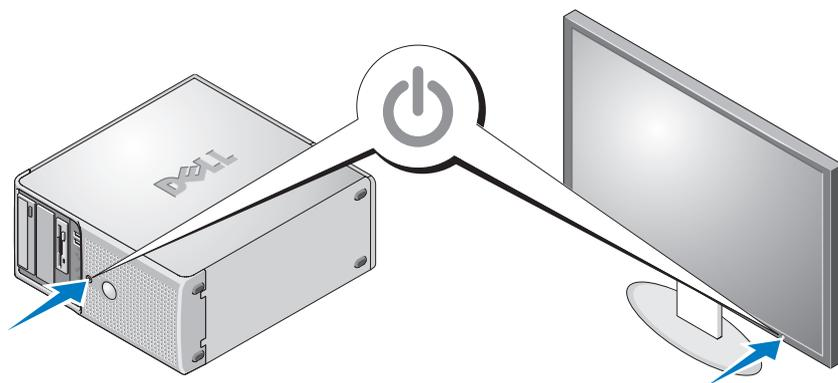
Нажмите кнопку питания на системе и мониторе. Должны включиться индикаторы питания. Отрегулируйте монитор для получения нужного качества изображения.
