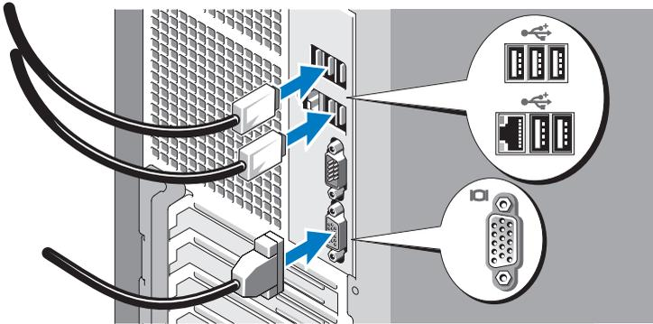
Schließen Sie die Tastatur, die Maus und den Bildschirm (optional) an. Die Anschlüsse auf der Rückseite des Systems sind mit Symbolen gekennzeichnet, mit denen sich die entsprechenden Kabel zuordnen lassen. Denken Sie daran, gegebenenfalls die Schrauben am Stecker des Bildschirmkabels festzuziehen.
