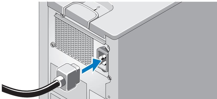
Zapojte napájecí kabel systému do systému. Poté zasuňte druhý konec napájecích kabelů do uzemněné elektrické zásuvky nebo je připojte k samostatnému zdroji napájení, například k jednotce UPS nebo jednotce rozvaděče (PDU).
