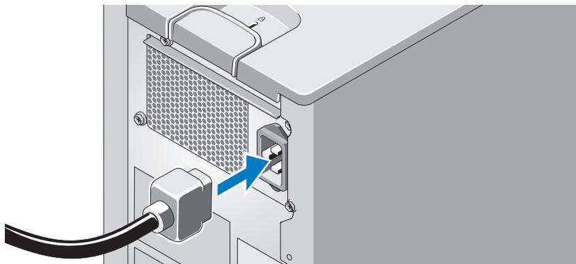
Podłącz kabel zasilania do komputera. Teraz podłącz drugą końcówkę kabla do uziemionego gniazdka elektrycznego lub oddzielnego źródła zasilania, np. do zasilania bezprzerwowego (UPS) lub do jednostki rozdziału zasilania (PDU).
