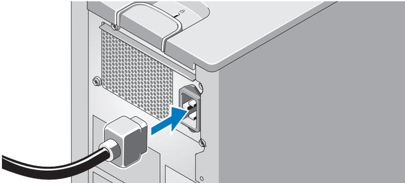
Verbinden Sie das Netzstromkabel mit dem System. Verbinden Sie dann das andere Ende des Netzstromkabels mit einer geerdeten Steckdose oder mit einer separaten Spannungsquelle, etwa einer unterbrechungsfreien Stromversorgung (USV) oder einem Stromverteiler (PDU).
