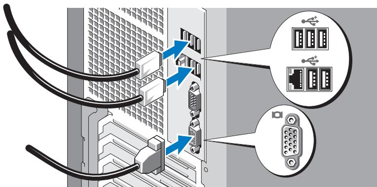
Подключите клавиатуру, мышь и монитор (дополнительный).
